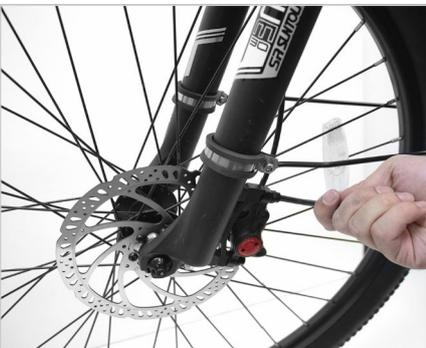
Les freins à disque hydrauliques utilisent une huile de freinage à base d'huile minérale. Vous pouvez utiliser de l'huile minérale d'autres marques, mais assurez-vous que l'huile utilisée est adaptée au freinage des vélos:
